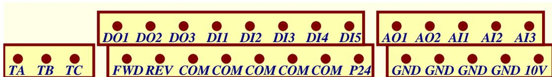
图 3-14 控制回路端子排序图
