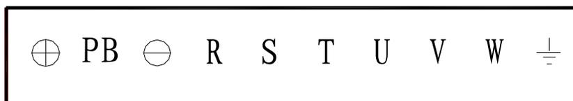
图 3-4 15KW 及以下规格主回路端子组成
